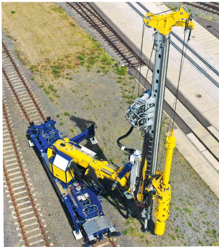
Das Gesamtsystem besteht aus dem Trägergerät mit Mäkler auf Basis einer RTG RG 18 S. Weil zwischen Mäkler und Hauptgerät in Transportstellung nur die Hydraulikleitungen fest verbunden sind, ist ein Transport als normales Eisenbahnfahrzeug möglich.
